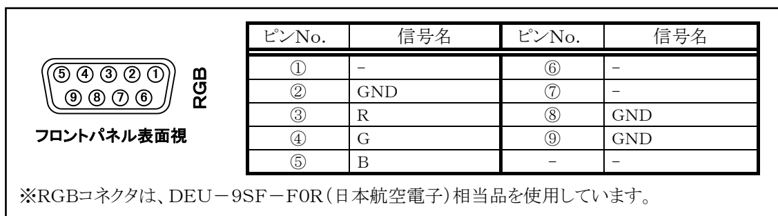
図1-7 RGBコネクタのピン配置
