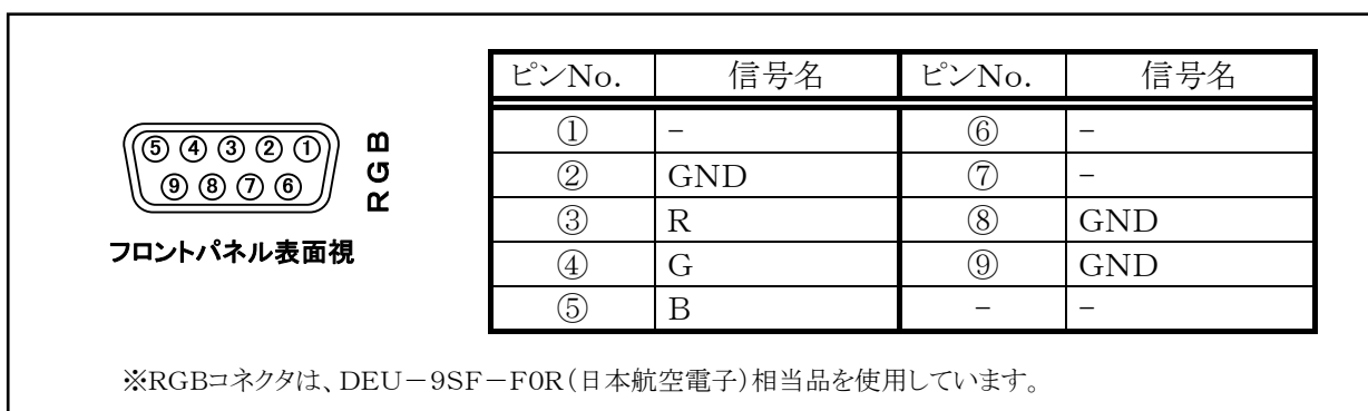
図2-14 RGBコネクタのピン配置
