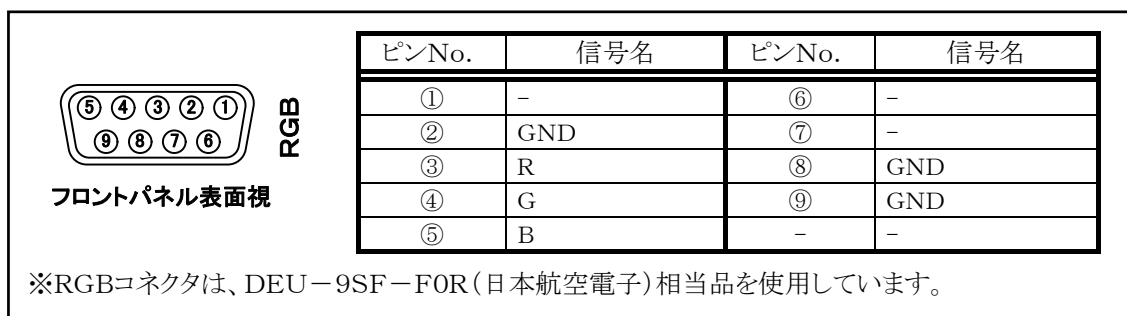
図1-7 RGBコネクタのピン配置
