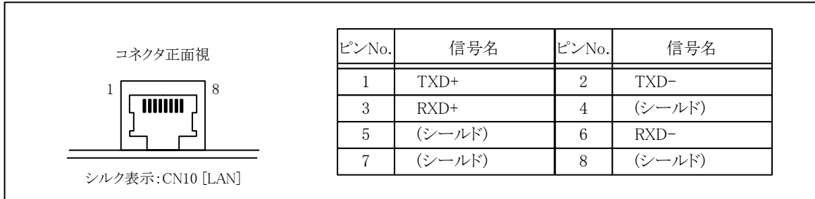
図2-11 Ethernetコネクタピン配置
